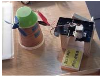
手回しで発電して風車を回す実演。
